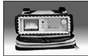
PRK3CP/PRK3CDG/PRK4CP 是宝马电子 PRK 系列场强仪和频谱分析仪家族最新成员, 精度和可靠性可满足 TV/FM/SAT/CATV/DVB 系统频谱和场强的高精度测量, 适用于模拟和数字电视信号, 符合欧洲标准。
